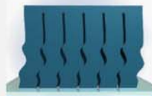
MICHELIN PATENT Dreidimensionale Lamellen
