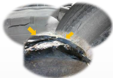
過酷な“ねじれ”に起因したセパレーションによる損傷
